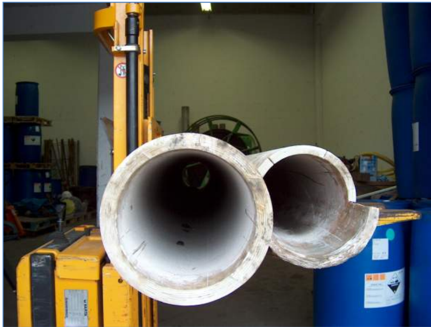
Figure 1 : Tubes (9 5/8 ) en matériaux composites remontés au jour après 13 ans de service (puits de production GLCS1 de La Courneuve Sud) (source : GPC IP).
